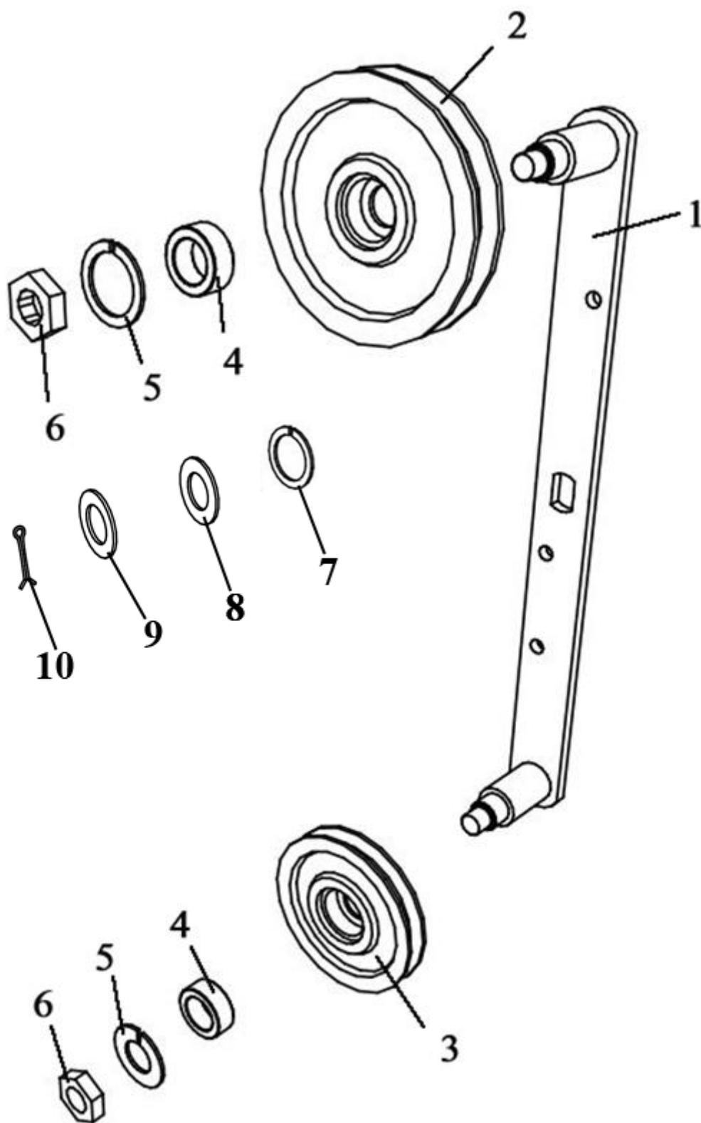
Рис. 14 УСТРОЙСТВО НАТЯЖНОЕ
