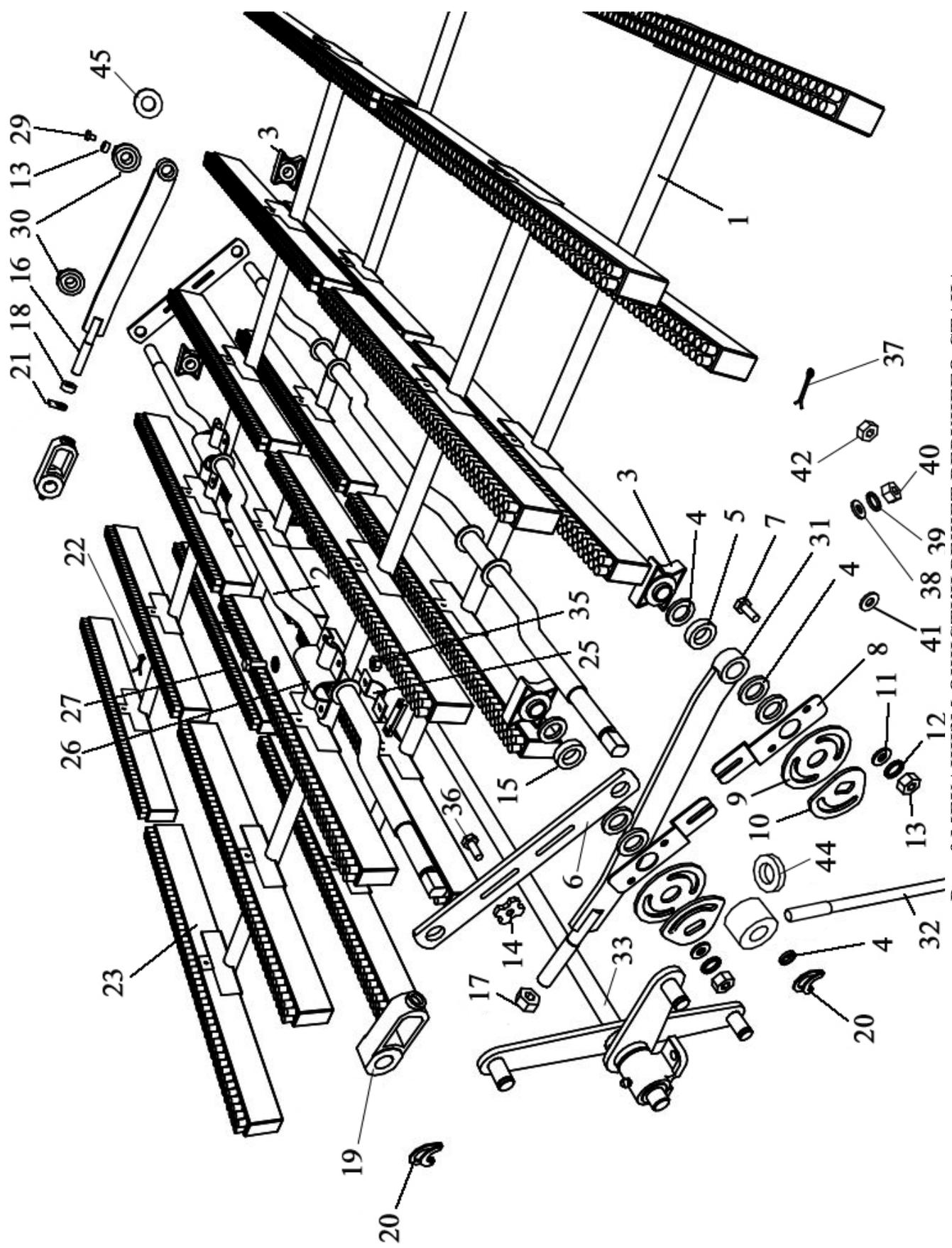
Рис. 9 МЕХАНИЗМ ОЧИСТКИ РЕШЕТ ВЕРХНЕГО СТАНА
